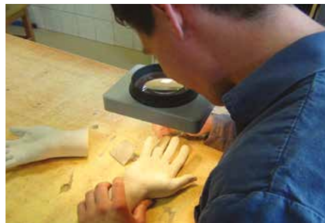
Obr. 4 Kompenzační pomůcka: světelná lupa. Používá se k osvětlení a přiblížení předmětu pro slabozraké
