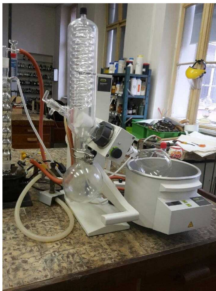
Vakuová odparka Rotavapor R-100 používaná především v laboratořích z organické chemie.
