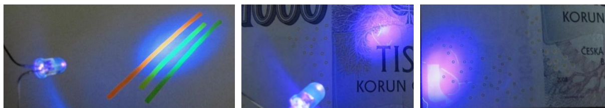
Obr. 24. Fluorescence vzbuzená zářením UV LED
