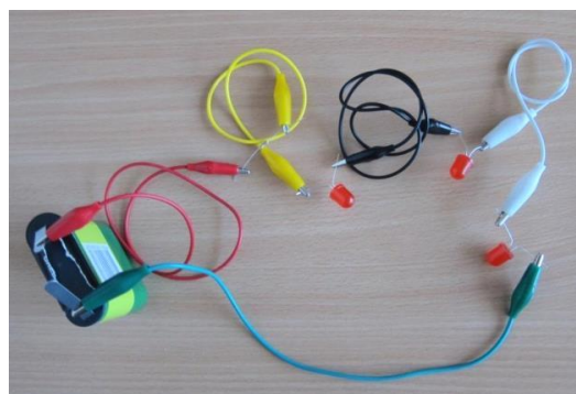
Obr. 7. Tři svítivé diody v sérii připojené k baterii 4,5 V nesvítí, i když jsou všechny zapojeny v propustném směru
