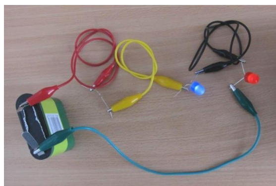
Obr. 11. Modrá a červená LED v sérii připojené k baterii 4,5 V svítí
