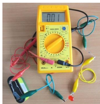
Obr. 18. Měření proudu tekoucího LED v závěrném směru
