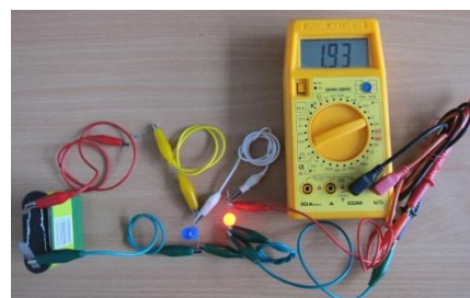
Obr. 22. Na paralelně zapojených LED je napětí asi 2 V
