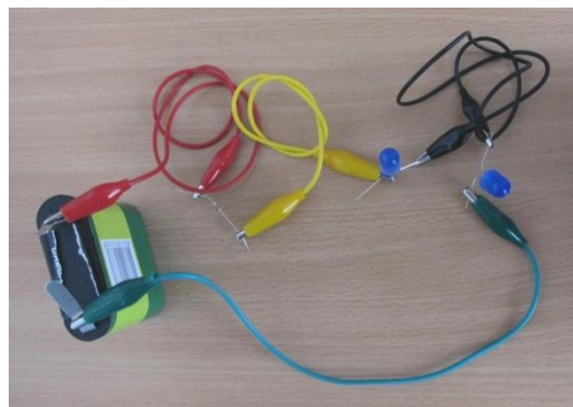
Obr. 10. Dvě modré LED v sérii připojené k baterii 4,5 V nesvítí
