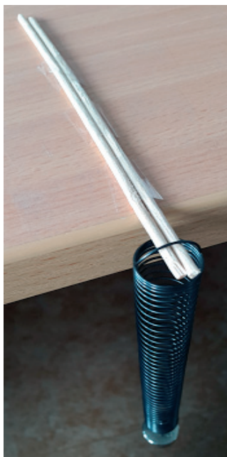
Obrázek 3. Pružina se závažím na improvizovaném stojánku
